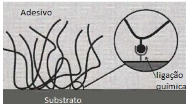
Figura 16 b) Esquema de adesão por adsorção química [21]
