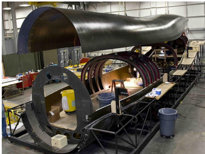
Figura 3: Montagem da fuselagem do cargueiro X-55A. [4]
