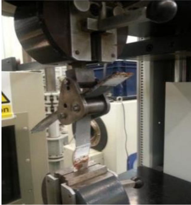
Figura 29: Esquema de ensaio de arrancamento [fonte: própria].
