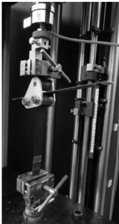
Figura 25: Máquina utilizada para ensaio de arrancamento Floating roller peel test [29]
