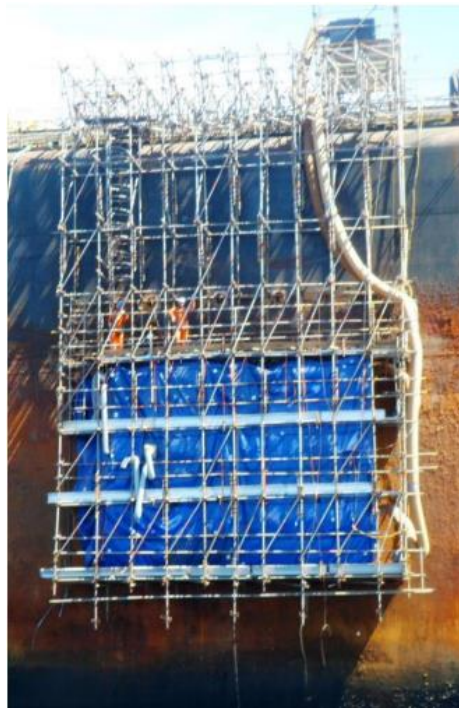
Figura 11: Aplicação de material compósito em casco de navio [15]
