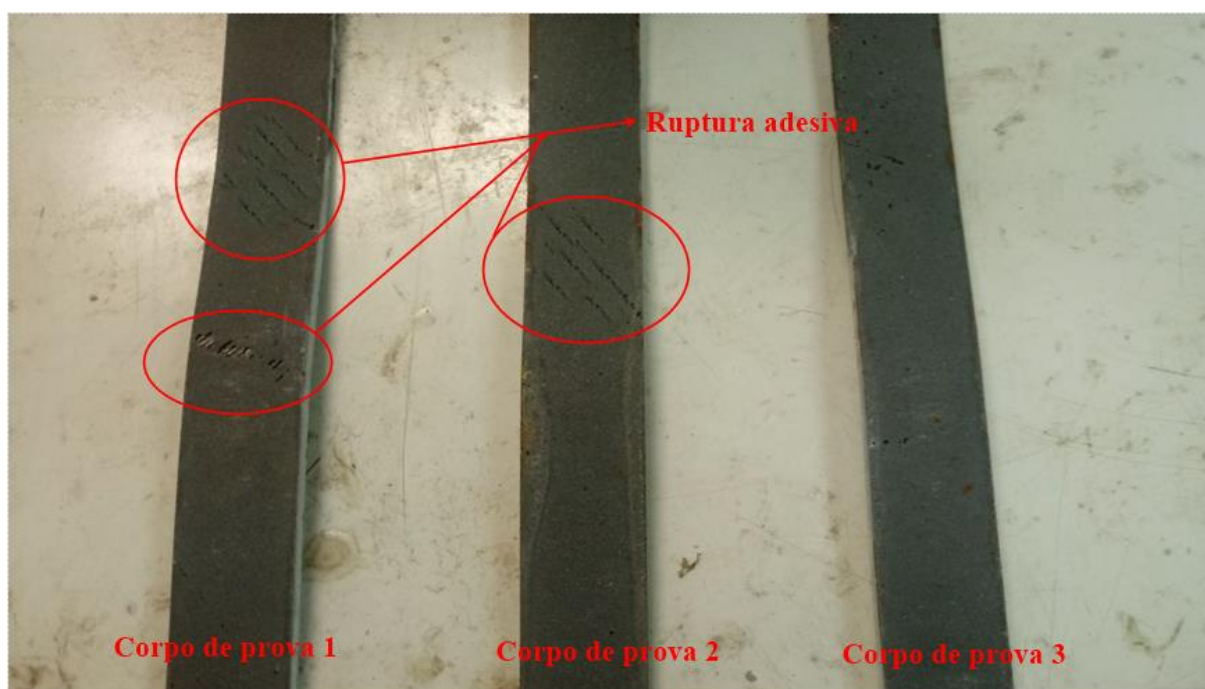
Figura 33: Corpos de prova envelhecidos 150 dias em aquário após ensaio de arrancamento [fonte: própria].
