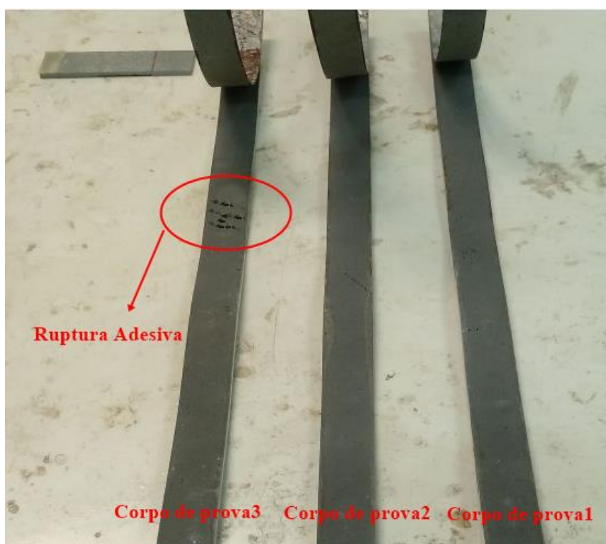
Figura 31: Corpos de prova envelhecidos 40 dias no tanque após ensaio de arrancamento [fonte: própria].
