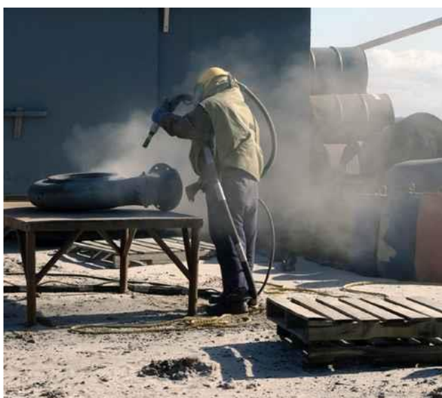
Figura 21: Processo de jateamento com areia [26].
