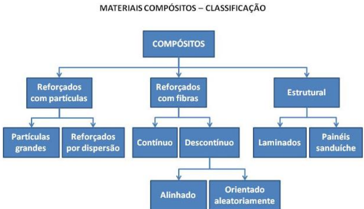
Figura 2: Esquema de classificação para vários tipos de compósitos [3]
